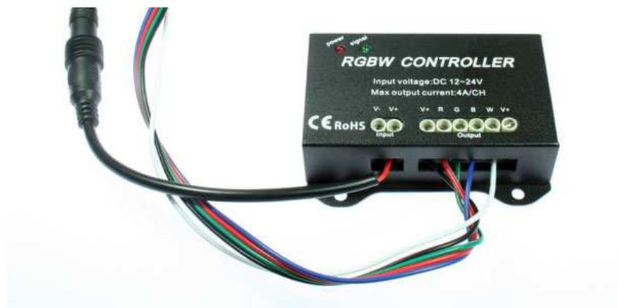
**INPUT:** dies entspricht die elektrische Versorgung.
